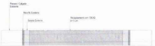
DETALHE DO RECAPEAMENTO
