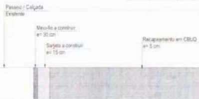
DETALHE DO RECAPEAMENTO
